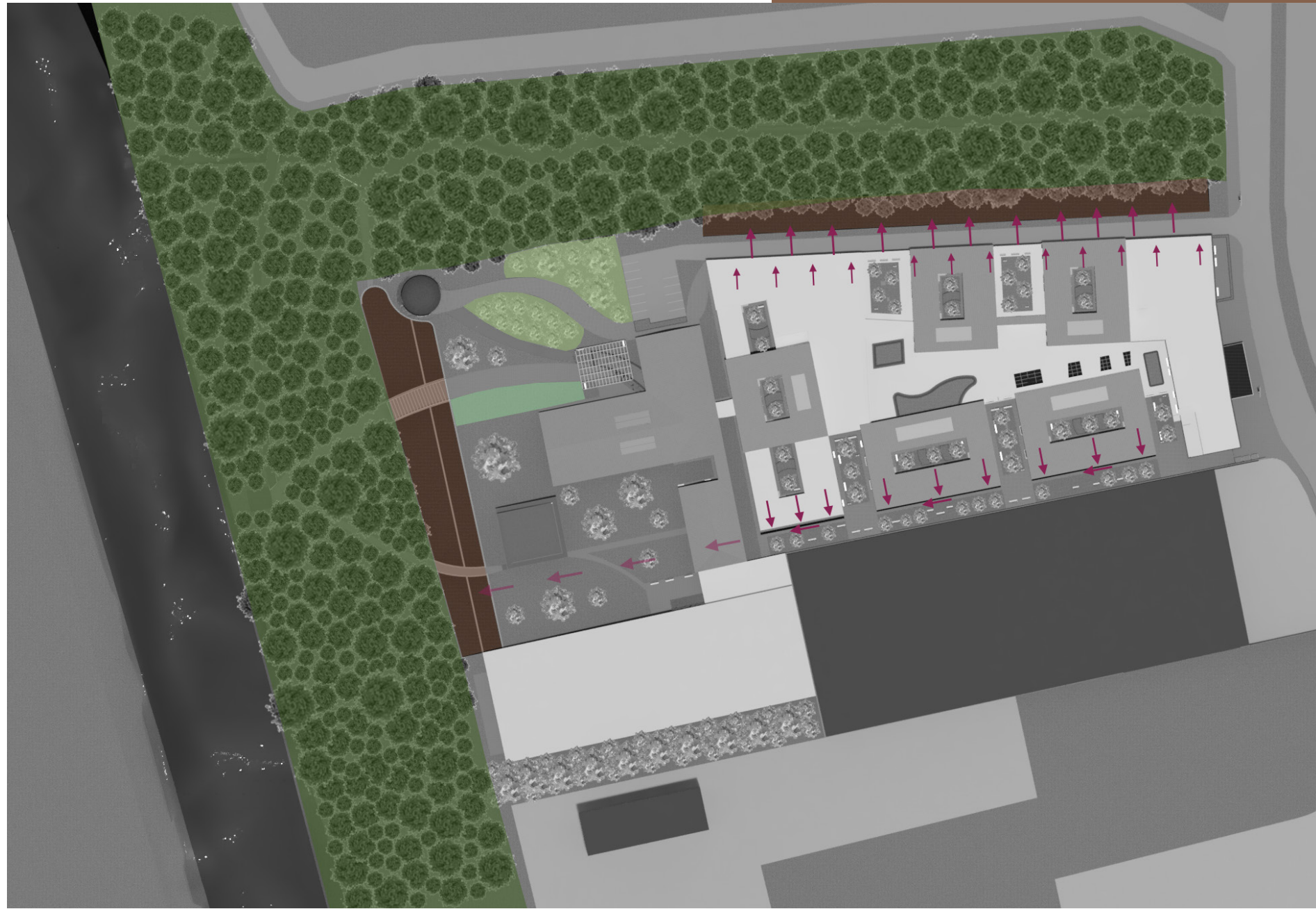
Imagem 48.2: bacias de retenção e caminho das águas pluviais.
